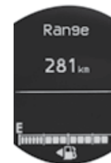
DISTANCIA PARA VACÍO DE TANQUE DE COMBUSTIBLE
